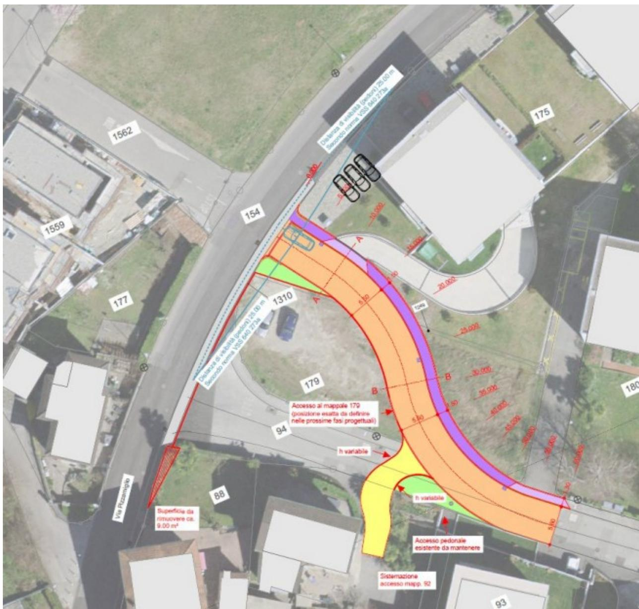
Verifica visibilità pedoni per i veicoli in uscita da Via Fornasette (secondo norma VSS 640 273a)
